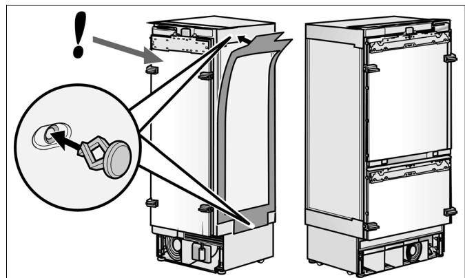
5. 并列安装方式配件包中有吸湿片，请用粘合带固定在侧壁上。
