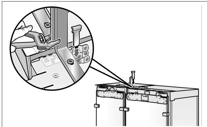
14. 用水泵钳在设备底座部位将两台设备完全压在一起。
