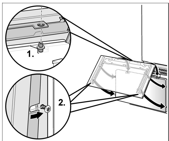
6. 用螺纹栓调整橱柜门 (Torx 星形螺丝起子)。检查四周间隙尺寸。
