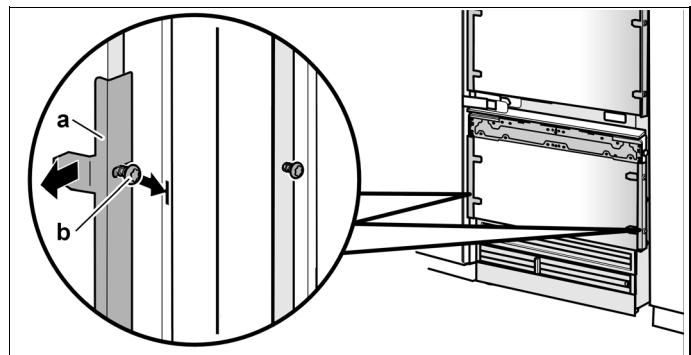
2. 将拿下的固定角铁 (a) 插入到橱柜门上的固定条 (b)。
