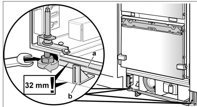
3. 用设备背面的螺纹脚将设备纵向调平。
