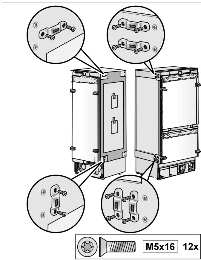
7. 并列安装方式配件包中有连接角铁，请用螺丝固定在两台设备上。
