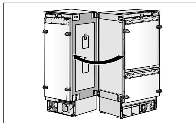
11. 旋出设备上面的螺丝，用防护倾覆角铁作为安装辅助用具替代且用螺丝旋上。
