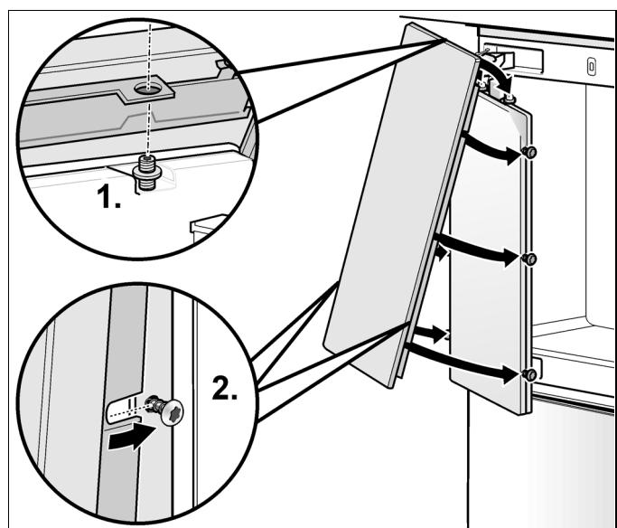
6. 用螺纹栓调整橱柜门 (Torx 星形螺丝起子)。检查四周间隙尺寸。
