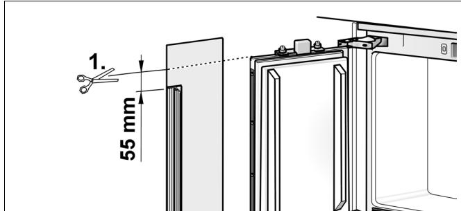
2. 剪断的护指装置片在门铰端插入到设备与安装空间壁的间隙中。
