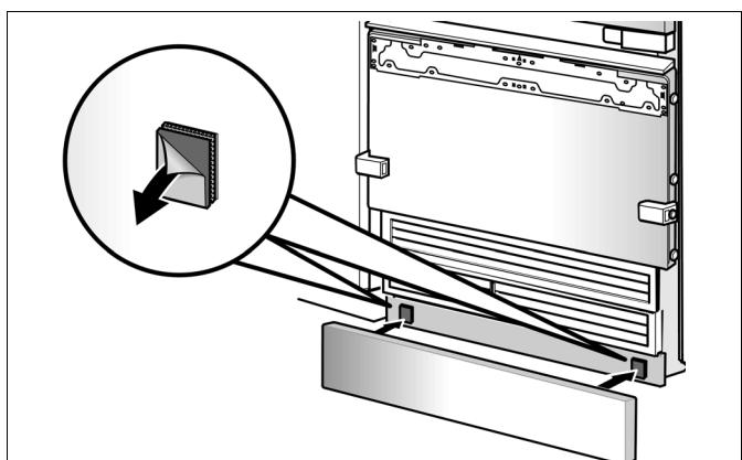
5. 底座板条可从后面用螺丝旋接到底座面板。
