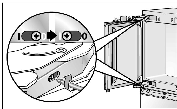
7. 将门铰安装在机器上。将门铰依交叉方向调换！
