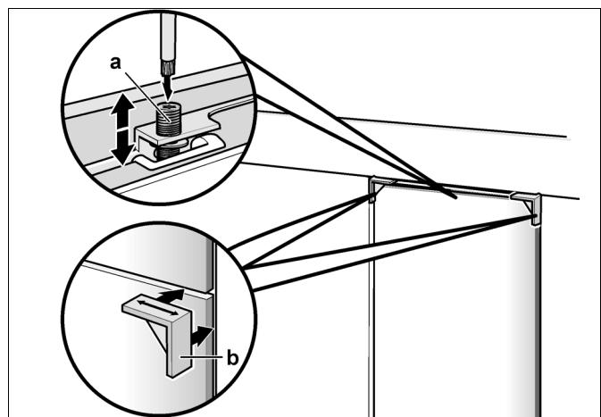
3. 将机器门外边缘固定螺丝的位置拿到橱柜门来，在橱柜门上也作相应标记。
