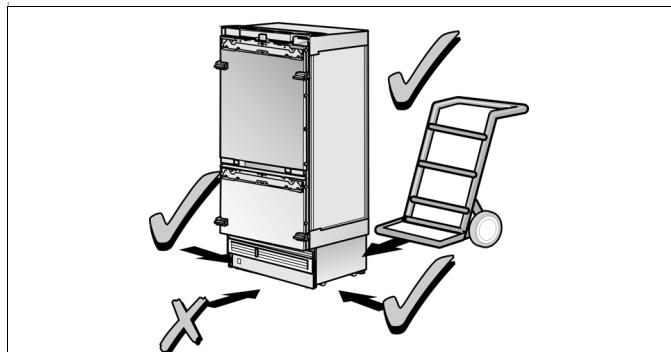
1. 用适于安装地点和设备的搬运工具将设备搬运 (双轮运小货件的手推车、升降式装卸车或有轮子的小车)。
