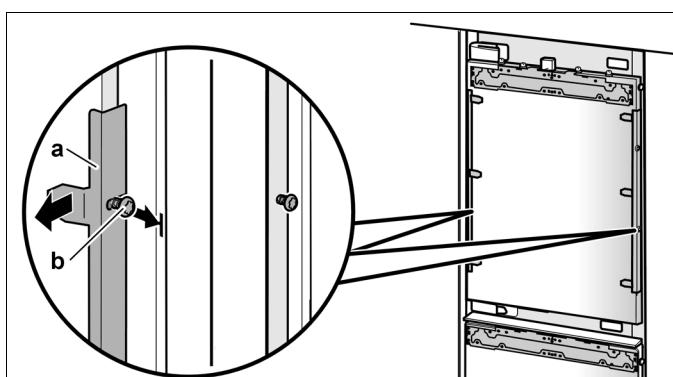
2. 将拿下的固定角铁 (a) 插入到橱柜门上的固定条 (b)。
