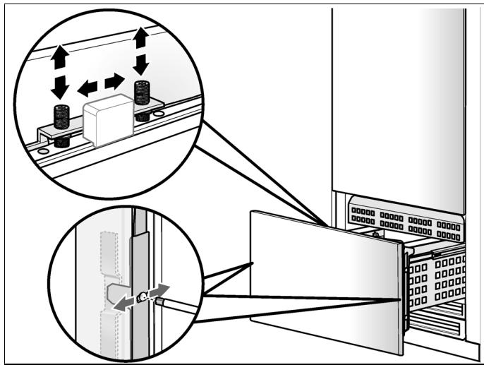
10. 将螺母旋在螺纹栓上并拧紧。如此可固定橱柜门的横向定位。
