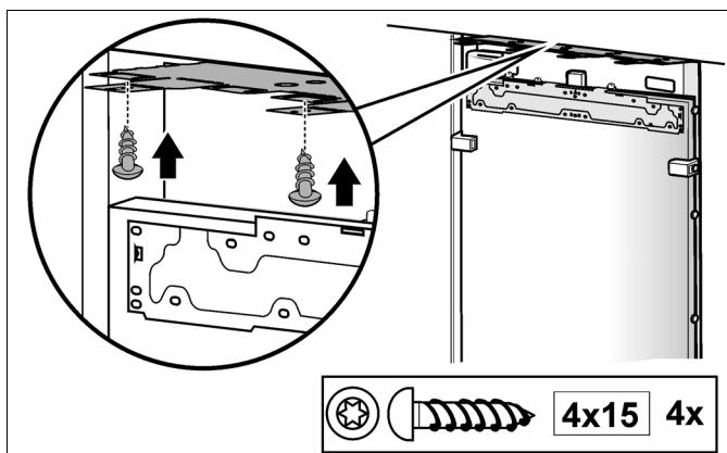
3. 如果设备上方还有足够的空间，可依周围安装条件将固定板(上)的两侧叶片固定。
