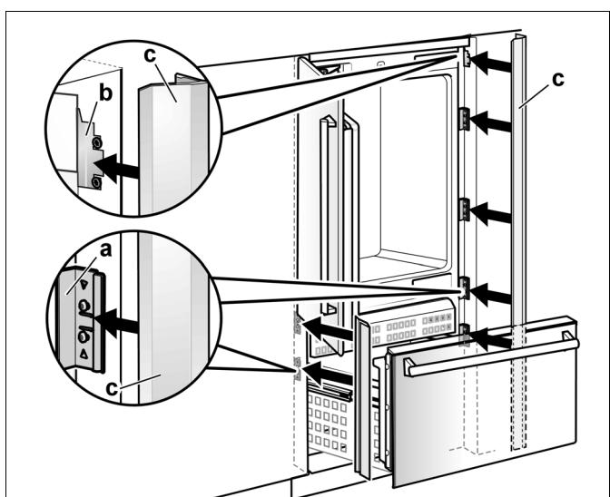
5. 将护板条装配在冷冻室抽屉的校准板之上。
