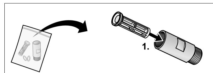
2. 将密封圈放入滤器外壳中并连接到水龙头(3/4"螺纹接头)。
