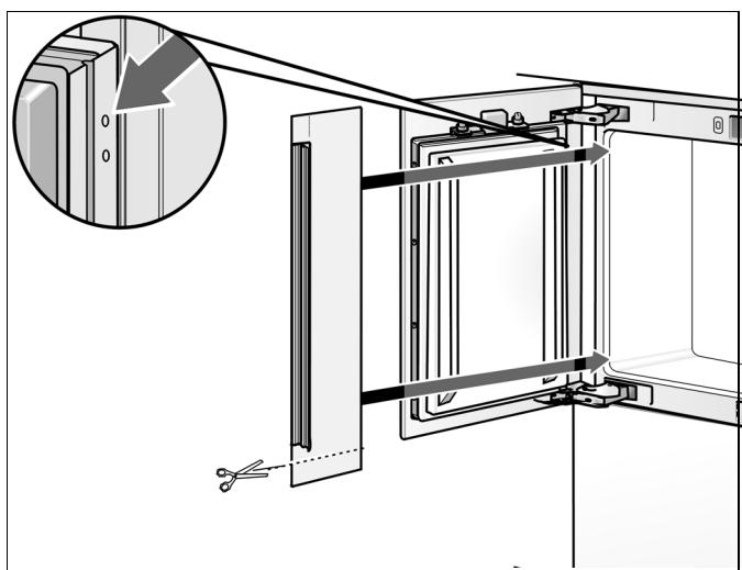
2. 将护指装置塞入设备和安装空间壁之间的间隙 (1.)。
