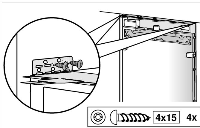
4. 截短安装条(a)，用于填补缝隙。
