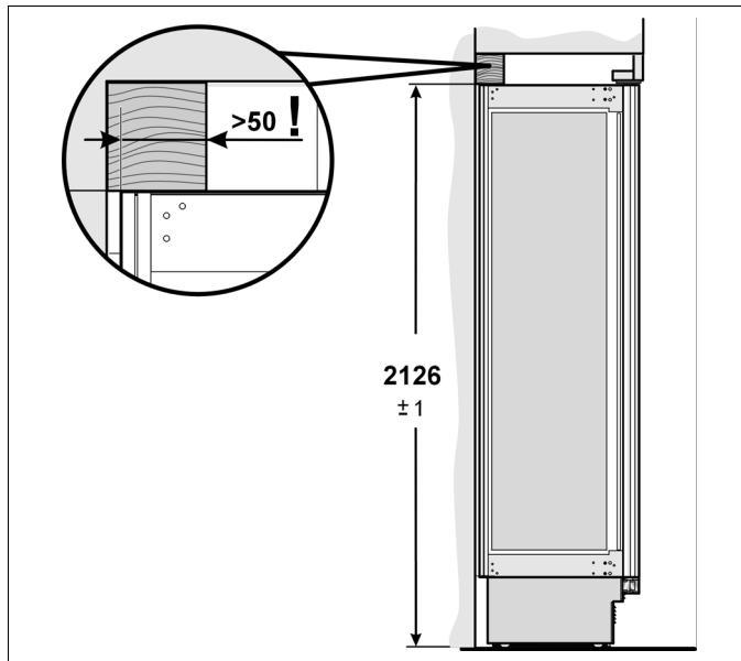
2. 在安装空间后壁画安装高度的标记（木梁下边缘）。
