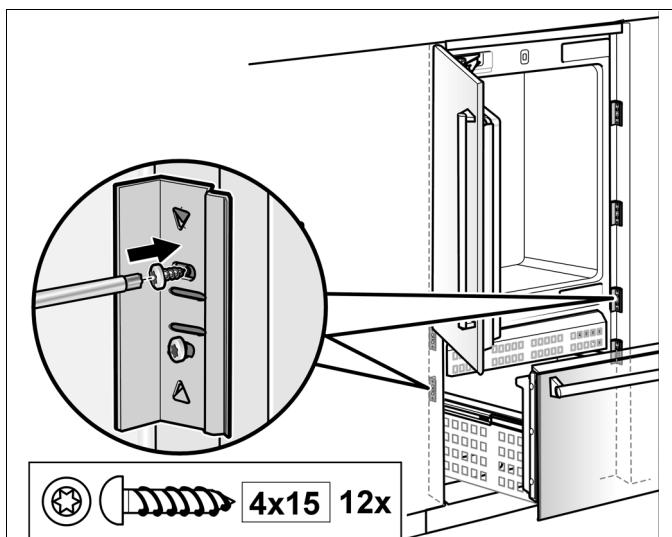
4. 将护板条 (c) 装配在固定板 (b) 和角铁 (a) 上。
